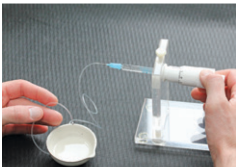
37. att. Ar manipulatora palīdzību no Gilmont mikrometra izvada fizioloģisko šķīdumu, panākot, ka šķīdums viengabalaini piepilda polivinila šļauku. Šļaukā fizioloģiskajam šķīdumam ir jābūt bez gaisa burbuļu klātbūtnes.
