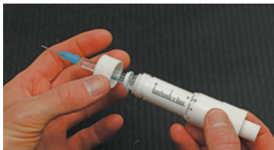
31. att. Stikla cilindru nofiksē ar O gredzenu un fiksējošu uzgriezni.
