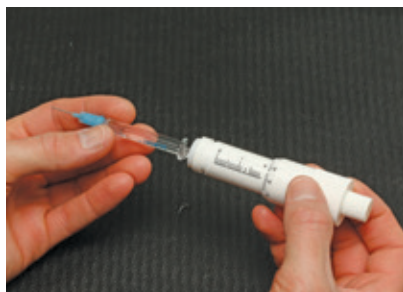
30. att. Gilmont mikrometra plunžeru savieno ar stikla cilindru, tā, lai starp plunžeru un fizioloģisko šķīdumu neveidotos gaisa burbuļi.
