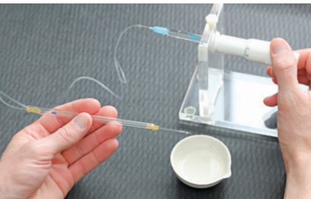
47. att. Ar manipulatora palīdzību no Gilmont mikrometra izvada fizioloģisko šķīdumu, rezultātā šķīdums piepilda lateksa savienotāju un apsūklošanas kapilāru. No Gilmont mikrometra fizioloģisko šķīdumu izvada tādā apmērā, lai rastos brīva vieta spermas uzņemšanai. Piemēram, ja darba procesā plānots uzpildīt 100 \mu l spermas uzkrāšanas cauruli, tad no Gilmont mikrometra izvada lielāko daļu fizioloģiskā šķīduma, tajā atstājot vien ap 50–70 \mu l.
