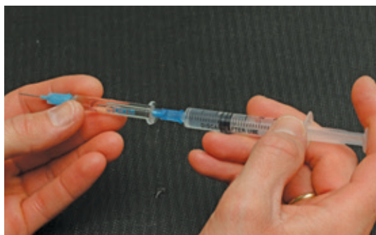
29. att. Vienreizlietojamās šprīces adatu ievieto Gilmont mikrometra stikla cilindrā un to uzpilda ar fizioloģisko šķīdumu, adatu pakāpeniski virzot laukā no cilindra. Gilmont mikrometra stikla cilindra uzpildīšanu ar fizioloģisko šķīdumu veic akurāti, lai fizioloģiskais šķīdums būtu viengabalains un bez gaisa burbuļu pārrāvumiem.
