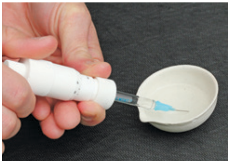
33. att. Mikrometru pilnībā uzpilda ar fizioloģisko šķīdumu. To panāk, Gilmont mikrometra adatas galu pilnībā iegremdējot fizioloģiskajā šķīdumā, un, lai izvairītos no gaisa ieraušanas mikrometrā, sākotnēji nelielu fizioloģiskā šķīduma daudzumu no tā izvada, un tikai tad seko šķīduma uzņemšana cilindrā.
