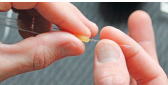
45. att. Stikla apsūklošanas kapilāru ievirza 3–5 mm dziļi lateksa savienotāja brīvajā galā.
