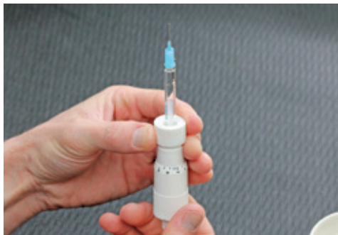
32. att. Pagriežot Gilmont mikrometra manipulatoru, pagarina plunžeru, rezultātā no stikla cilindra un adatas gala izvada lieko gaisu. Dažkārt viegls piesitiens adatas galam palīdz atbrīvot tur esošos gaisa burbuļus.
